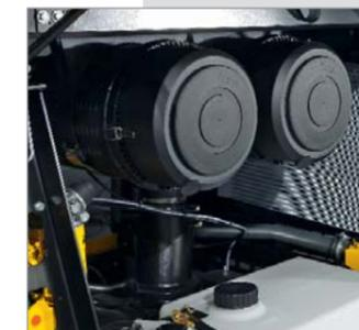
**Separate Luftfilter für Motor und Kompressor**
